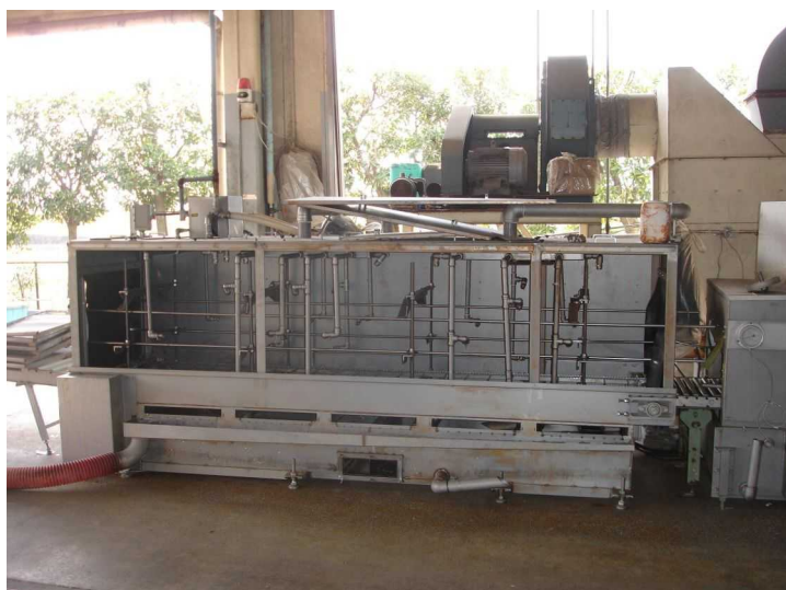
コンテナ洗浄機
